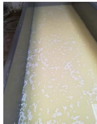
Abbildung 6 Käsewanne für heimische Produkte (ohne Rühr- und Schneidwerk)
