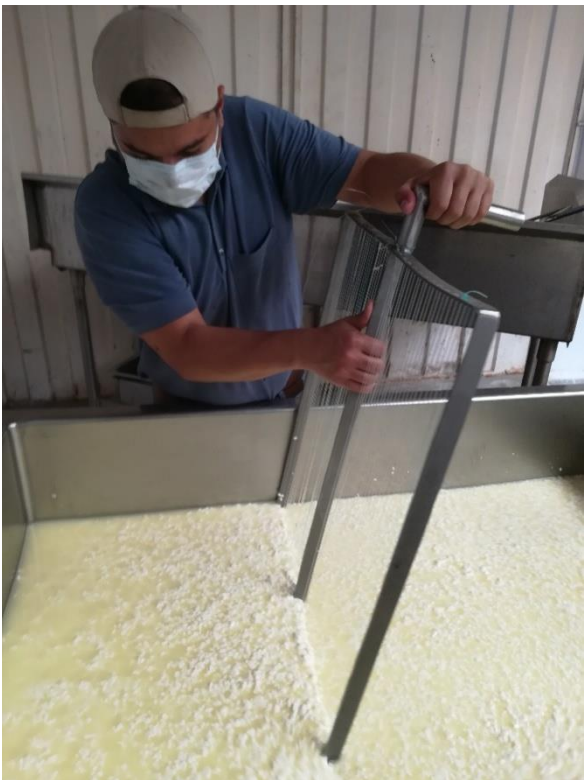
Abbildung 8 400 l Käsewanne (mit Rührwerk für meine Produktion)
