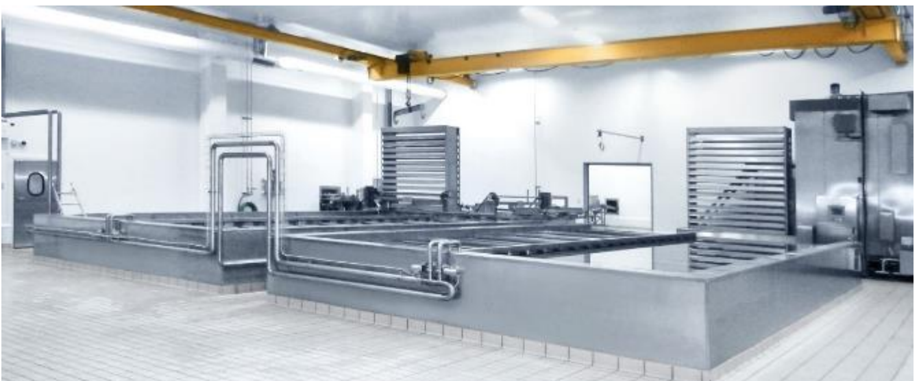
Salzbad mit automatisierter Be- und Entladestation
