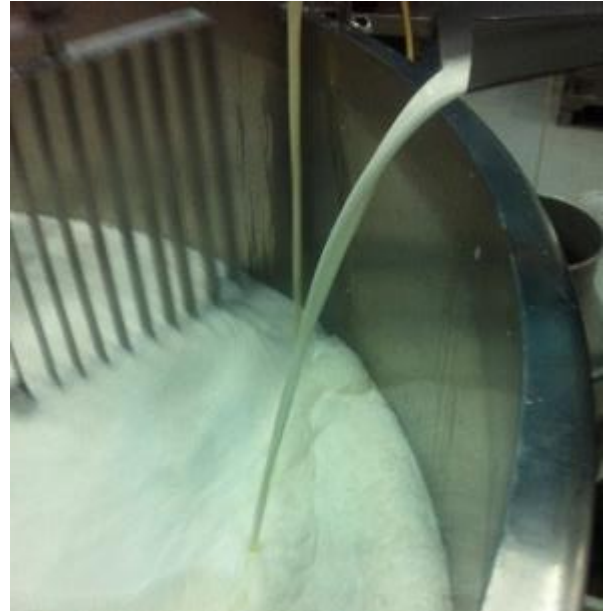
Käsefertiger wird befüllt
