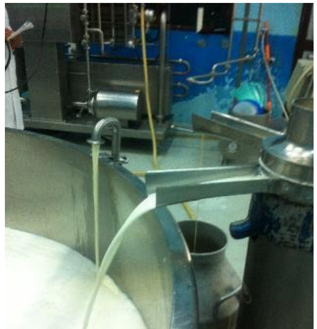
Im Hintergrund der Milcherhitzer, rechts der Separator, links der Käsefertiger
