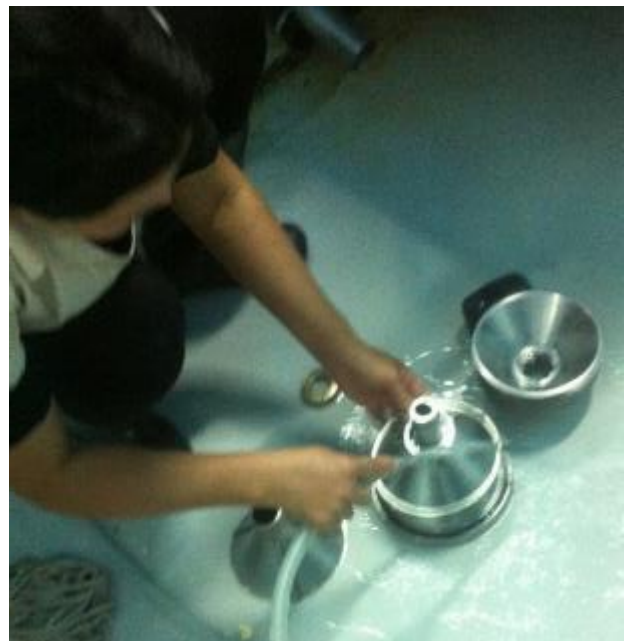
Teile vom Separator werden auf dem Boden mit kaltem Wasser gereinigt
